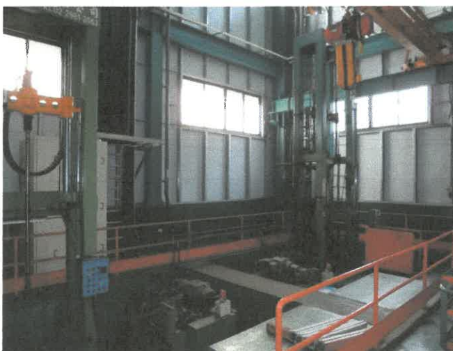
大型自動大型旋盤 MAX 内径 1,000mm Max 長 2,600mm
