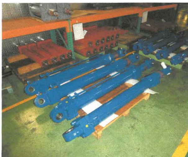
造管成型機用特注シリンダ
