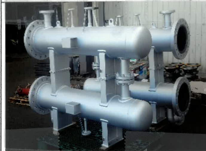
HEATER SHELL ASME SA105 1790×600×1700H 単重 500kg
